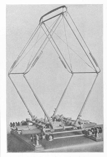
Fig. 13. — Appareil de prise de courant.
