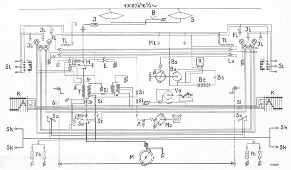
Fig. 15. - Schéma des connexions de la locomotive 1-B-1.
