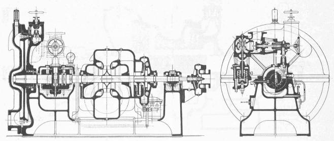
Fig. 35. — Condensation de la turbine de 9000 chevaux.
