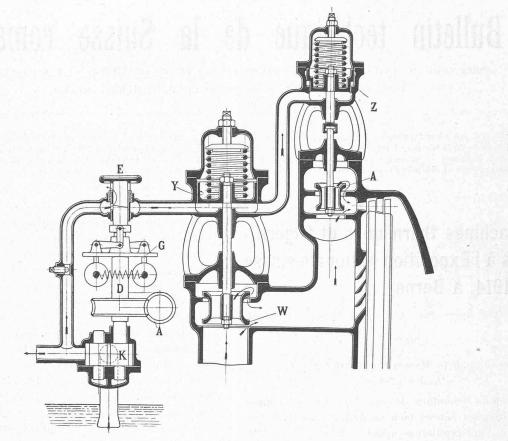
Fig. 30. - Schéma de réglage de la turbine B. B. C.
