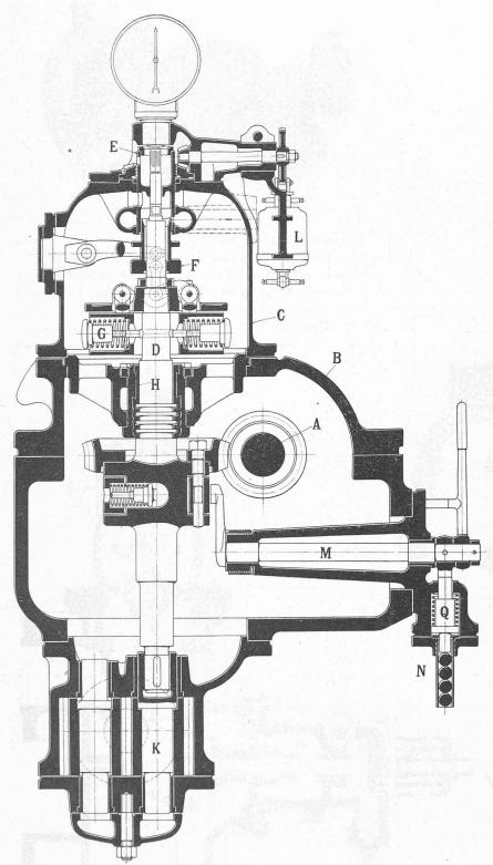
Fig. 32. — Régulateur de vitesse et de sécurité de la turbine B. B. C.
