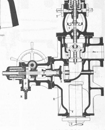
Fig. 33. — Mise en marche de la turbine B. B. C.
