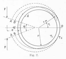
La dilatation de la face intérieure étant la plus grande, l'anneau devra s'ouvrir et formera un grand secteur d'anneau de rayon intérieur R et d'angle  $2\pi-\varphi$ , où  $\varphi$  est l'angle d'ouverture des deux lèvres de la fente supposée. Nous aurons alors les équations
