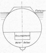
Fig. 1. – Sous-marain américain, système Holland. Sections circulaires. Water - ballasts intérieurs. Coefficient de flottabilité: 13 %. Déplacement: 106/122 tonnes. Lancé en 1900.
