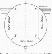
Fig. 2. — Sous-marin français Farladel, système Maugas, lancé en 1901. Sections circulaires. Coefficient de flottabilité: 7 %. Déplacement: 184/200 tonnes.
