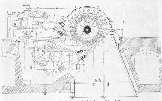
Fig. 17. — Turbine Pelton pour l'usine de Saaheim. — Echelle 1 : 60.  $H=253~{\rm m.}$  ;  $N=16~400~{\rm HP}$  ;  $n=250~{\rm t./min}$ .
