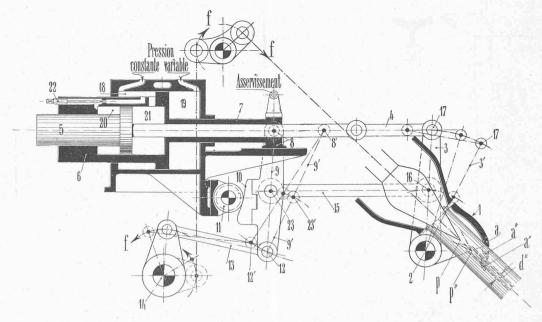
Fig. 20. — Schéma du régulateur à double action de la turbine de Saaheim.
