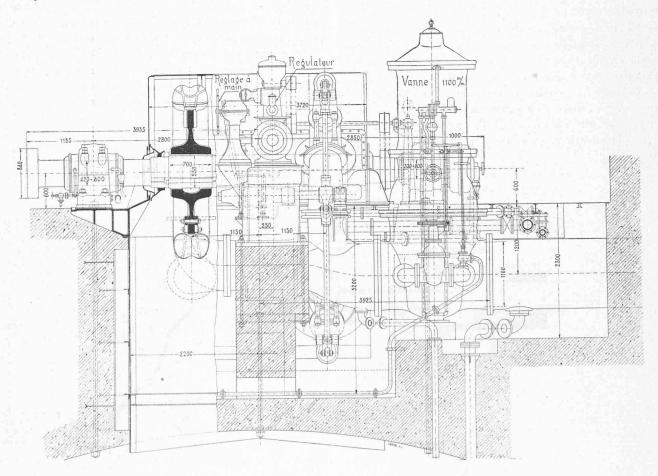
Fig. 18. — Turbine Pelton pour l'usine de Saaheim. — Echelle 1 : 60.  $H=253~{
