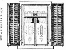
pour manœuvrer les volets à fenêtres fermées.
