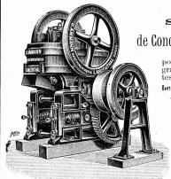
Concasseur-broyeur à cylindre.
