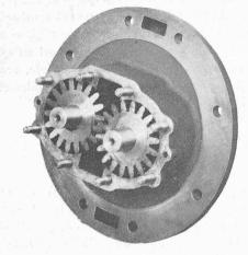
Fig. 11. - Pompe à engrenages destinée aux petits régulateurs.
