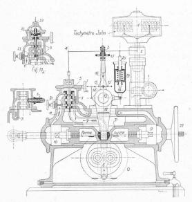
Fig. 10 et 10 a. - Schéma d'un régulateur normal.
