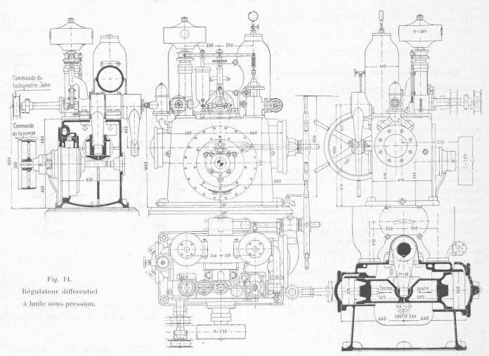
La soupape 21 permet de réunir, de « court-circuiter ». les côtés 9 et 10 du cylindre du servo-moteur; cette opération s'effectue lorsque l'on veut substituer le réglage à mains au réglage automatique.
