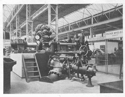
Fig. 2. — Turbine Pelton destinée à l'Usine de la Borgne.  $H=340~{\rm m.}$ ;  $Q=2250~{\rm l./sec.}$ ;  $N=8250~{\rm HP}$ ;  $n=300~{\rm t./min.}$
