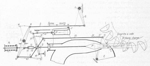
Fig. 5. – Turbine Pelton, de la Borgne : Schéma du réglage double.
