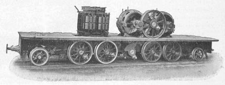
Fig. 3. — Châssis avec moteur (côté collecteur) et transformateur.
