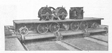
Fig. 4. — Châssis avec moteurs (côté engrenage) et transformateur.
