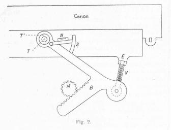
le niveau N (dont la bulle est entre ses repères quand le canon est horizontal) l'angle de site S mesuré sur le secteur divisé s, puis on fait tourner le berceau autour de T' au moyen du pignon M et de la crémaillère B jusqu'à ce que la bulle du niveau soit revenue entre ses repères: l'inclinaison de la bouche est alors égale à l'angle de site S. Pour
