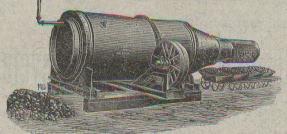
Machine à layer le sable et le gravier combiné avec trieur.
