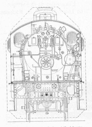
Fig. 48. – Vue des appareils de contrôle et de mise en marche.
