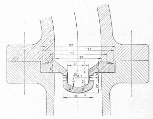
Fig. 8. — Coupe du diaphragme de rupture. — 1:3.
