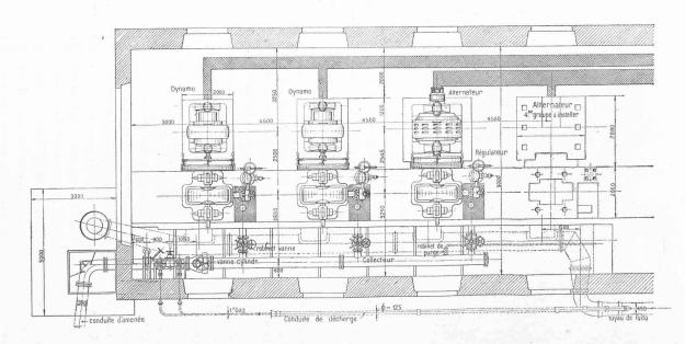
à celle-ci par un coude en acier coulé. Il a 350 mm. de diamètre intérieur et comprend actuellement 3 tuyaux en tôle soudée de 18 mm. d'épaisseur, assemblés par boulons et brides mobiles comme la partie inférieure de la conduite. Ces tuyaux portent les tubulures de raccordement pour 3 turbines et diverses autres prises pour des appareils dont il sera fait mention ensuite. Le tuyau avec la tubulure pour la quatrième turbine sera placé en même temps que cette machine.
