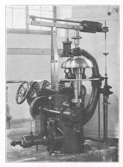
Fig. 13. — Régulateur automatique de vitesse, construit par les *Ateliers de Vevey*,
