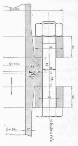
Fig. 3. - Assemblage des tuyaux soudés. - 1:5.
