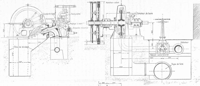
Fig. 10, 11 et 12. — Turbine Pelton de 750 HP; 750 tours par minute. — Echelle 1:40.
