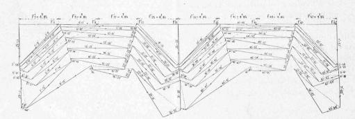
Fig. 3. — Tensions produites par l'action du vent. — Echelle : 1 cm. pour 3 T.
