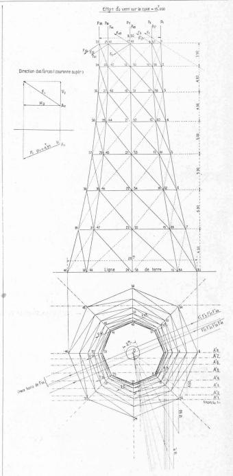
Fig. 1. — Projections de la tour. Echelle : 8 mm. pour 3 m. — a = 1.00 m.
