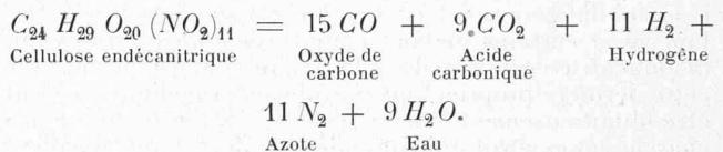
Les caractéristiques du fulmi-coton comprimé sont :  $t=2380^\circ$ ;  $v=6383$  m./sec.;  $P=11127$  kg./cm $^2$ ;  $E=2076589$  kgm.
