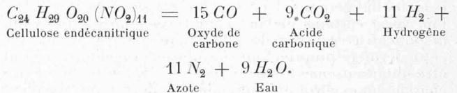
Les caractéristiques du fulmi-coton comprimé sont :  $t=2380^\circ$ ;  $v=6383$  m./sec.;  $P=11127$  kg./cm $^2$ ;  $E=2076589$  kgm.
