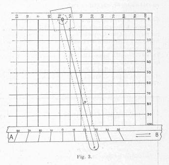
d'abord déplacé horizontalement jusqu'à ce que le point O soit sur la verticale correspondant à l'altitude de la station (422 m. 8); si la mire est à la distance  $78 \, \text{m.} \, 7$ , son altitude est 442,3 (point P du diagramme); la plaque de verre est en réalité divisée en millimètres; la pente en 0/0 se lit sur la règle mobile A B.
