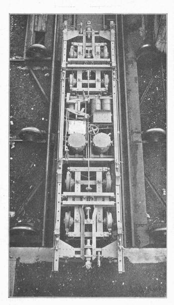
Fig. 3. — Vue supérieure du truc-transporteur M.-O.-B., avec paliers à billes.
