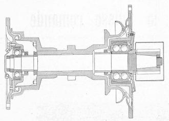
Fig. 1. — Coussinets à billes de l'induit du moteur. — 1:10
