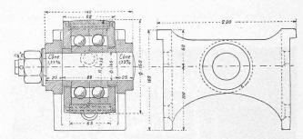
Fig. 6. — Segments d'appuis latéraux entre châssis et bogie.
