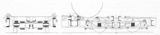
Fig. 4. — Truc-transporteur à paliers à billes du M.-O.-B. et du chemin de fer Zweisimmen-Lenk. — Coupe longitudinale et transversale du bogie. — 1 : 30.
