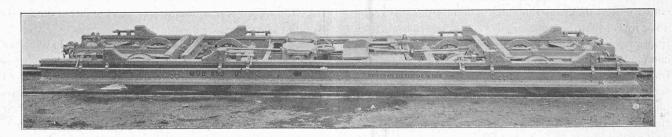
Fig. 2. — Truc-transporteur M.-O.-B. avec paliers à billes Schmid-Roost, construit par la Fabrique suisse de wagons, à Schlieren.
