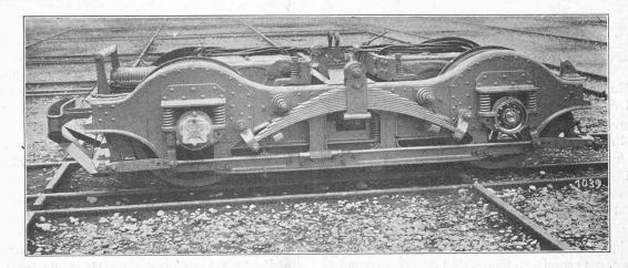
Bogie d'automotrice M.-O.-B. avec roues montées sur boîtes à billes.
