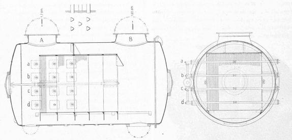
Fig. 41. - Réfrigérant d'air par injection.
