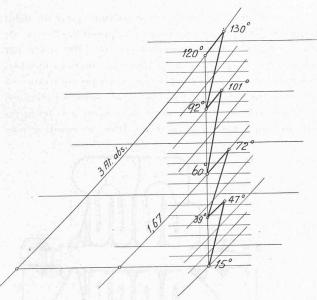
Fig. 39. — Diagramme d'entropie pour la réfrigération par la bâche.
