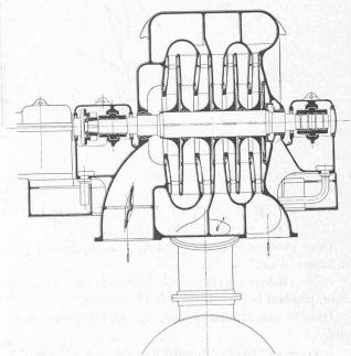
Fig. 38. — Turbo-soufflante à 4 étages pour 700 m³ d'air.
