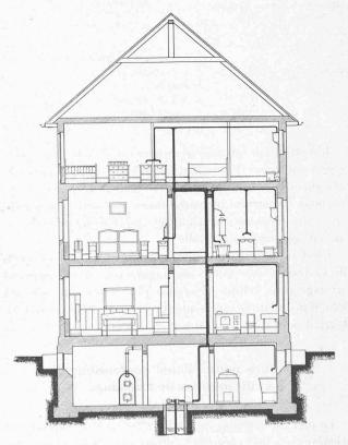
Fig. 5. — Schéma d'installation d'un service d'eau dans une maison.
