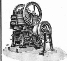
Concasseur-broyeur à cylindre,
