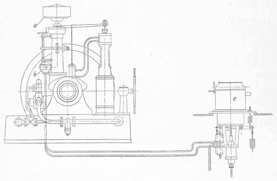
Fig. 15. — Régulateur de la turbo-soufflante.
