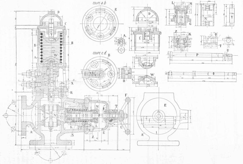
Fig. 23. — Détail de la soupape du régulateur. — Echelle — 1:4.
