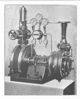
Fig. 21. - Turbo-pompe pour alimenter les chaudières.
