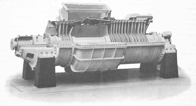
Fig. 24. — Modèle montrant les parties intérieures de la turbine de 8000 HP.
