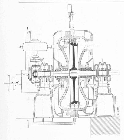
Fig. 19. - Turbine commandant le groupe de pompes de condensation.
