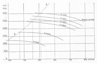
Fig. 17. — Caractéristique normale d'une soufflante.
