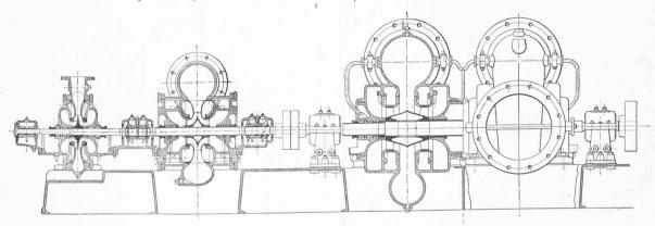
Fig. 20. — Groupe de pompes de condensation. — Echelle 1 : 25.
