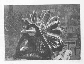
Fig. 9. — Moteur Gnôme, 18 cylindres, 200 HP.
