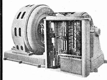
avec induit à bagues pour réglage successif du nombre de tours servant à actionner les machinesoutils:
