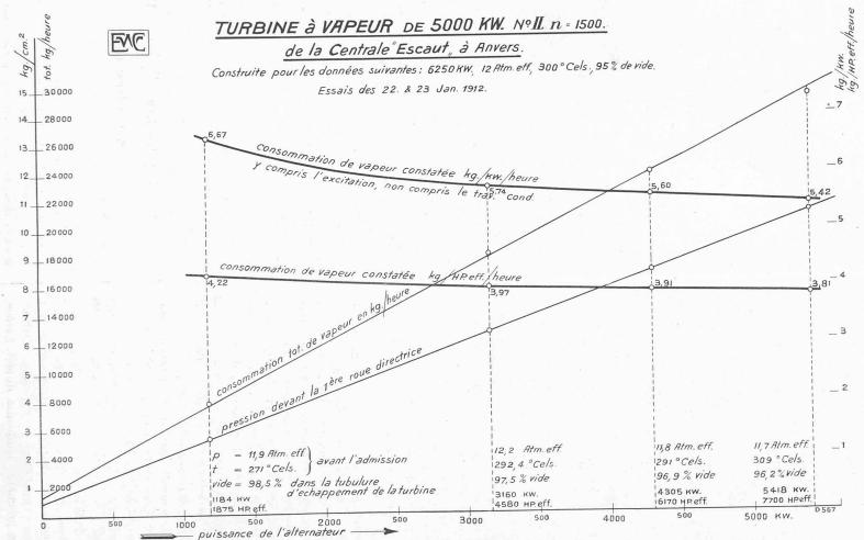
Fig. 9. — Essais d'une turbine de 7500 chevaux.
