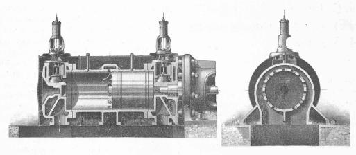
Fig. 3. — Coupes de la machine à vapeur Sulzer à flux continu.
