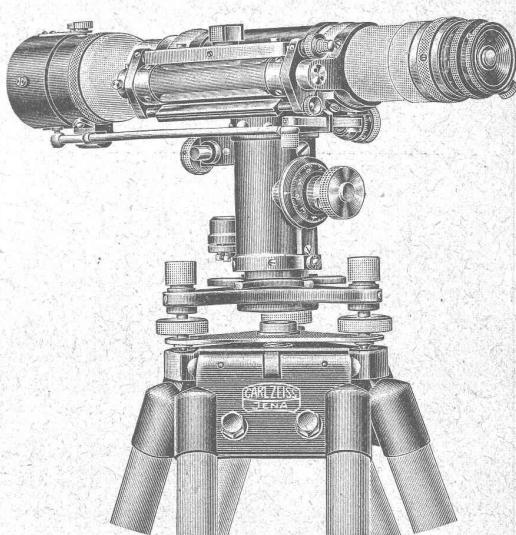
Les instruments pour des nivellements
