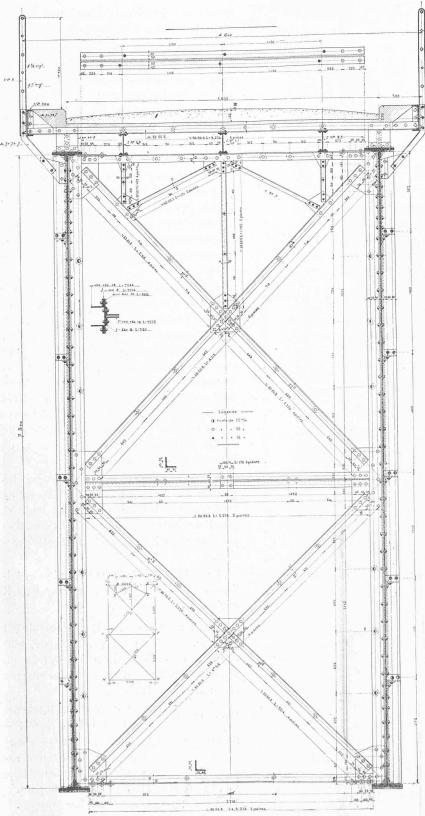
Fig. 3. — Coupe transversale sur pile. — 1:40.
