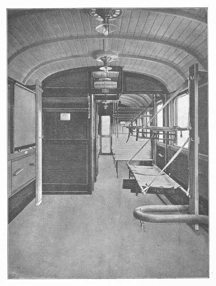
Fig. 21. — Voiture de  $\Pi\Pi^{me}$  classe, à 4 essieux, installée pour le transport des blessés.
