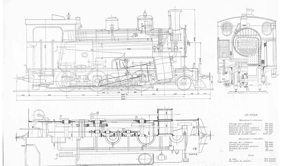
Fig. 18. – Locomotive à crémaillère fournie par la Société suisse pour la construction de locomotives et de machines, à Winterthour.
