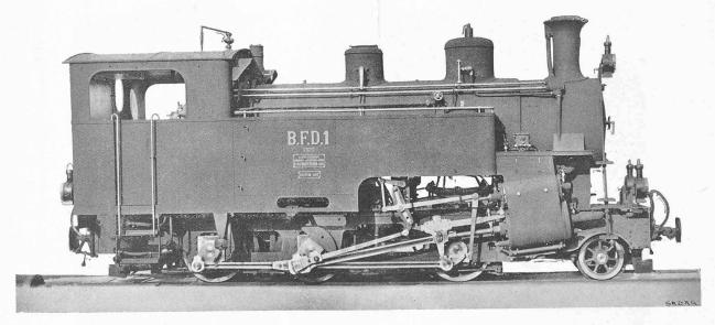
Fig. 17. — Locomotive à crémaillère tournie par la Société suisse pour la construction de locomotives et de machines, à Winterthour.
