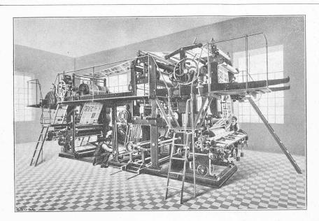
Machine rotative pour impressions en creux. Cette machine fonctionne dans les ateliers de la SADAG, à Bellegarde, et peut imprimer 15 000 exemplaires à l'heure.
