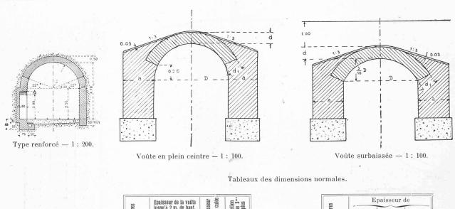
Epaisseur de la voûte jusqu'à 2 m. de haut. rembl. Epaisseur de la culée D  $0^{m}35$ 2,00 0,400,503,00 0.55 1,20 0,03 0.45 1.30 0.04 4.00 0.65 0.50 1,70 0,06 6,00 0,60 0,80 8,00 0,700,90 1,90 0,08 10,000,80 1,00 2, 10 0, 10
