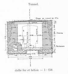
Tranchée couverte. dalle en béton armé.
