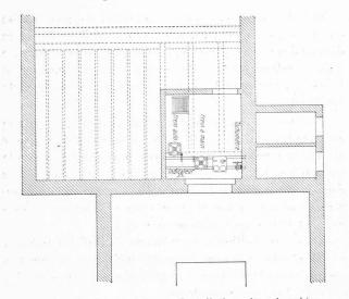
Fig. 8.— Station supérieure : Installations dans la cabine du mécanicien — 1:250.
