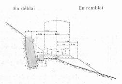
Mur de sontènement en maçonnerie à mortier -1:150.
