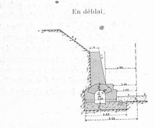
avec aqueduc voûté et mur de soutènement — 1 : 150.
