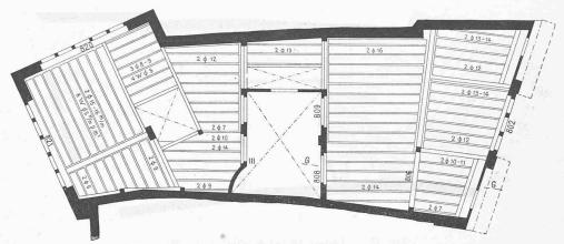
Fig. 10. — Plancher sur 2° étage. — 1 : 200.
