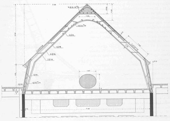
Fig. 8. — Coupe sur avant-corps. — 1 : 60. Les Grands Magasins de l'Innovation, à Lausanne.
