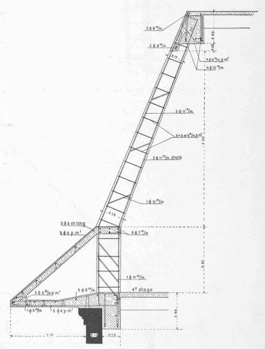
Fig. 6. — Armature du brisis au 4º étage. — Coupe. — 1:30.
