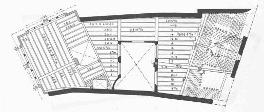
Fig. 17. — Toiture en béton armé. — 1:200.
