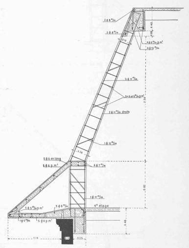
Fig. 6. — Armature du brisis au 4º étage. — Coupe. — 1:30.
