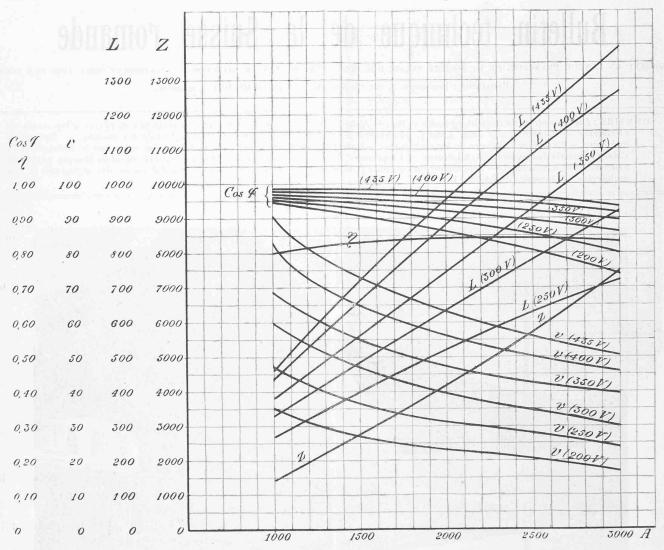
Fig. 12. - Courbes caractéristiques du moteur.
