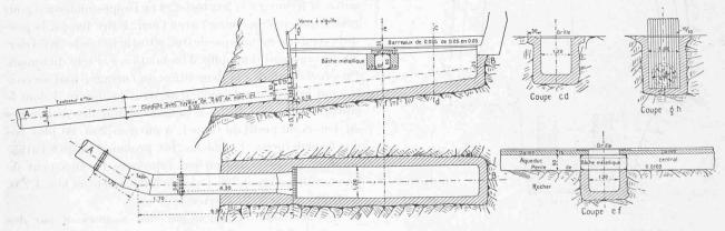
Fig. 25. — Tranchée là la tête du tunnel destinée à dériver les eaux dans la conduite de décharge. — 1:450.
