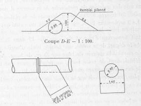
Dispositif d'arrêt, en maçonnerie, des tuyaux de conduite -1:100.
