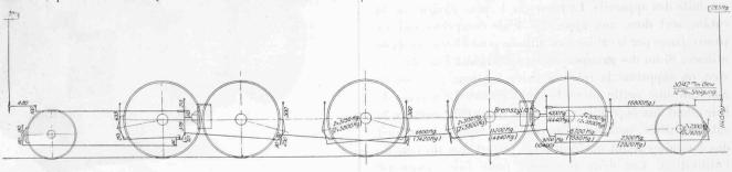
Fig. 3. - Schéma des freins.
