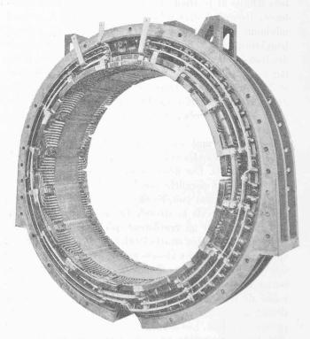
Fig. 10. - Stator du moteur de 1250 chevaux.
