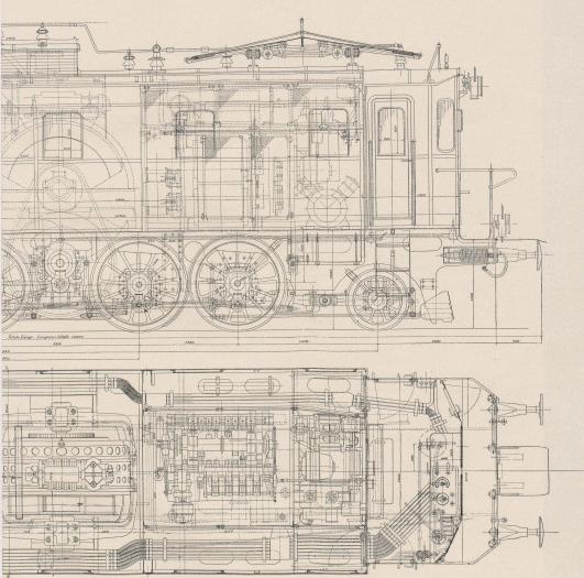
Locomotive électrique du Chemin de fer des Alpes bernoises, con uite par les Ateliers de Construction d'Oerlikon. - Echelle 1:40.
