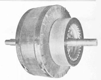
Fig. 9. - Rotor du moteur de 1250 chevaux.
