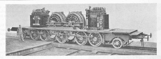
Fig. 2. - Châssis avec moteurs, transformateurs et controller.
