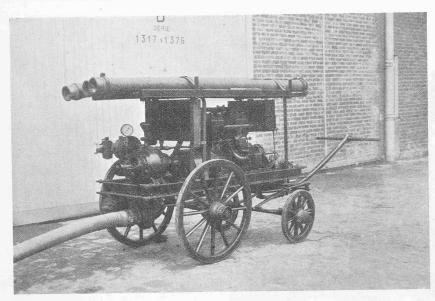
Fig. 22. — Pompe à incendie, avec moteur à essence, de la C<sup>ie</sup> Française des Automobiles de Place.
