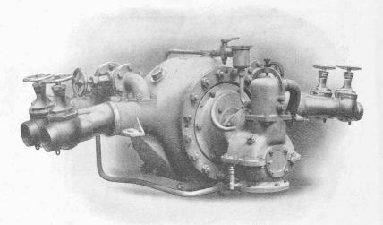
Fig. 18. — Pompe centrifuge Sulzer pour la pompe automobile à incendie Daimler « Strasbourg ».
