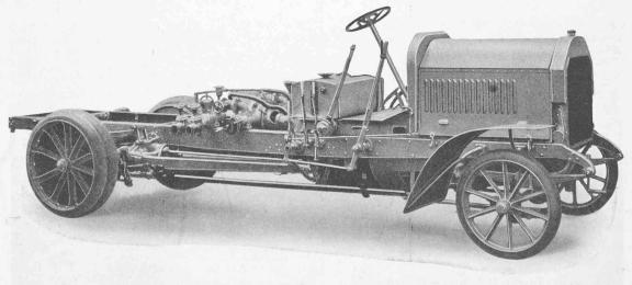
Fig. 17. — Pompe automobile à incendie «Daimler» avec pompe centrifuge Sulzer».
