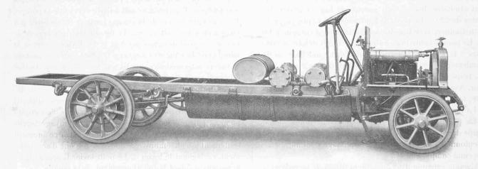
Fig. 15. — Châssis d'une pompe automobile à incendie Adler.
