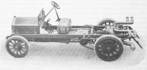
Fig. 2. — Châssis d'automobile Saurer avec pompe centrifuge Sulzer.
