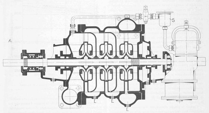
Fig. 3. - Coupe d'une pompe centrifuge à incendie Sulzer.
