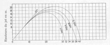
Fig. 6. — Portées du jet en m.\*pour une ouverture de lance
