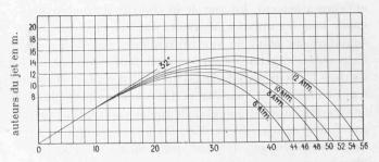
Fig. 7. — Portées du jet en m. pour une ouverture de lance de 18 mm.
