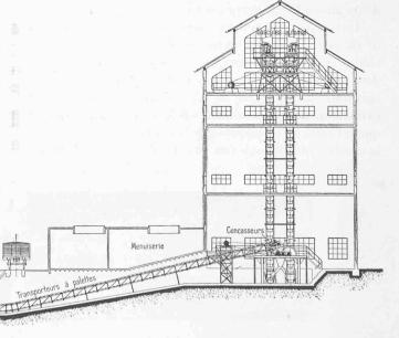
Fig. 32. — Magasins à charbons. Coupe sur le tunnel d'amenée.
