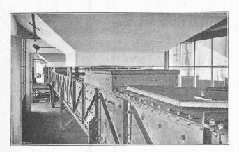
Fig. 37. - Reprise du charbon sous les silos.
