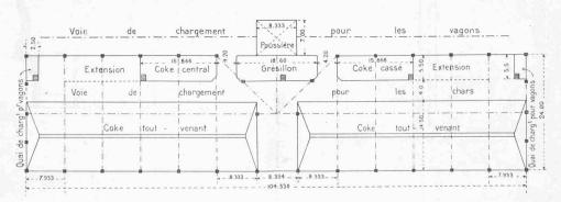
Fig. 39. - Distribution en plan de la halle à coke.
