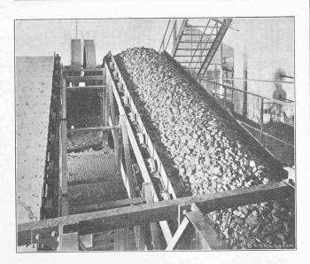
Fig. 33. - Arrivée du charbon aux concasseurs.
