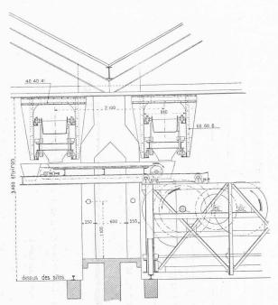
Fig. 36. — Transporteur de secours des ponts roulants.
