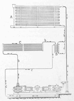
Fig. 10. - Installation frigorifique, système Sulzer.
