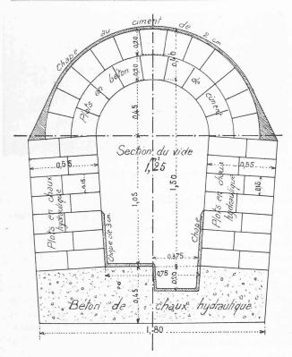
Fig. 11. – Section renforcée de l'égout collecteur principal. Echelle 1 : 250.
