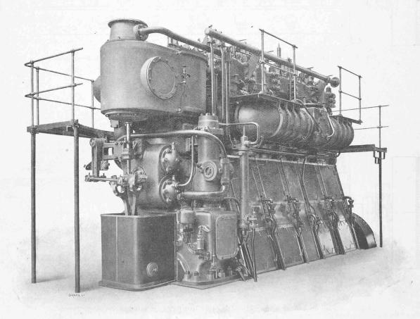
Fig. 7. — Moteur marin Sulzer-Diesel à deux temps de 1000 chevaux du Monte Penedo. Vue générale du côté de l'échappement.
