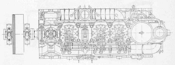
Fig. 5. — Plan du moteur marin Sulzer-Diesel de 1000 HP, à deux temps, du *Monte Penedo*.
