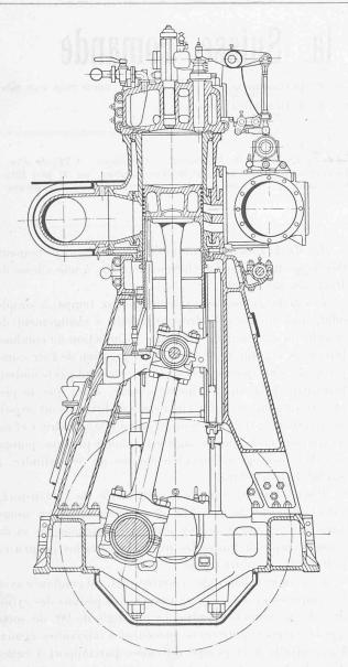
Fig. 2. — Coupe d'un cylindre de travail du moteur marin Sulzer-Diesel, de 1000 HP, à deux temps.
