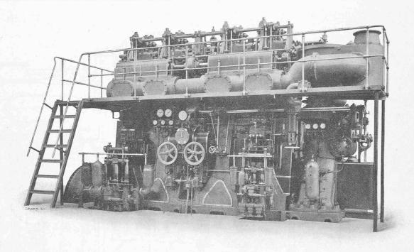
Fig. 6. — Moteur marin Sulzer-Diesel à deux temps de 1000 chevaux du  ${\it Monte Penedo}$ . Vue générale du côté de la distribution.
