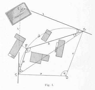
$T_4$  n'est pas visible de  $T_2$  et le point de concours des tangentes T est inaccessible.
