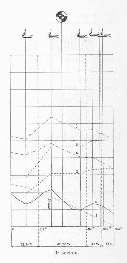
Fig. 15. — Diagramme de traction du câble aux stations motrices.
