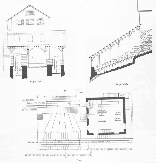
Fig. 20. — Station intermédiaire de Schwandegg. — 1 : 250.
