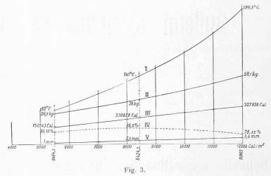
LÉGENDE : I = Température moyenne des gaz de la combustion dans le carneau. — II = Dépense de coke par heure. — III = Calories produites par heure. — IV = Rendement de la chaudière. —  $V = Tirage \ dans \ le \ carneau, \ en \ mm.$  d'eau.
